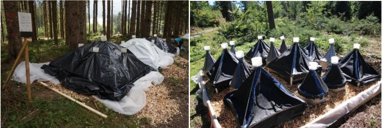
Abb. 1: links: Hackschnitzelhaufen mit wechselnder Folienabdeckung in weiß und schwarz, rechts: Abdeckung der flächig verblasenen Hackschnitzel mittels Bodenelektoren
