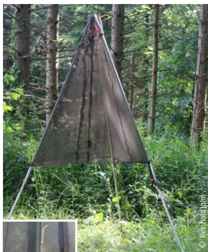
Abb. 49: Das Fangsystem Trinet® P wird mit einem Lockstoffdispenser versehen (kleines Bild). Das Netz wirkt insektizid.
